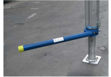
TITAN Megashore -säätöavaimella voi löysätä säätöruuvia kuorman kanssa (vipuvarsi 800 mm, paino 2,5 kg).
