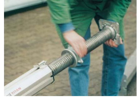
Nopea säätö saadaan löysäämällä lukitusmutteri, jolloin säätöruuvit pyörivät vapaasti.
