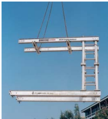
C-hook muottipöytien siirtämiseen.
