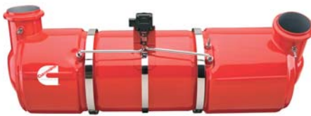
Dieselpartikkelisuodatin alentaa hiukkaspäästöjä huikeat 90 prosenttia.
